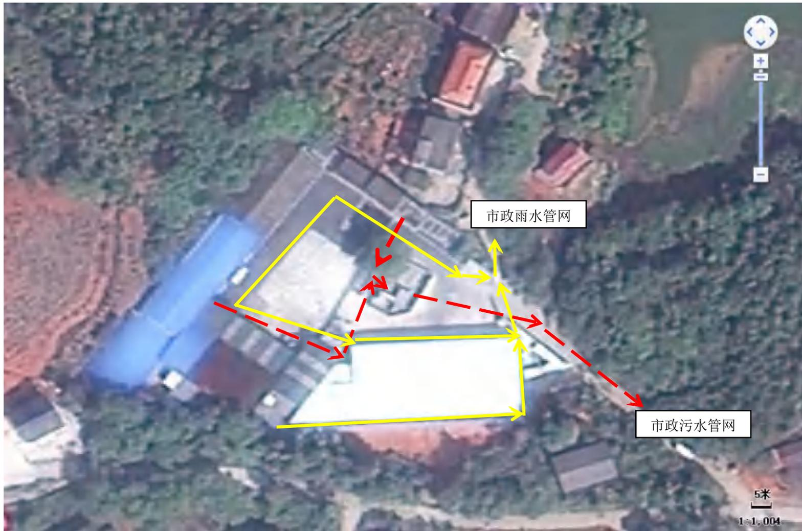
附图 4 厂内雨污水走向图
